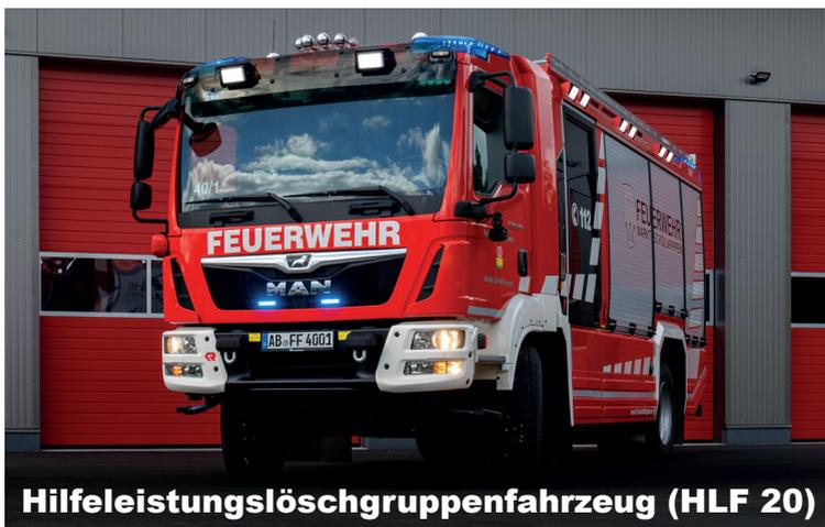
Hilfeleistungslöschgruppenfahrzeug (HLF 20)
